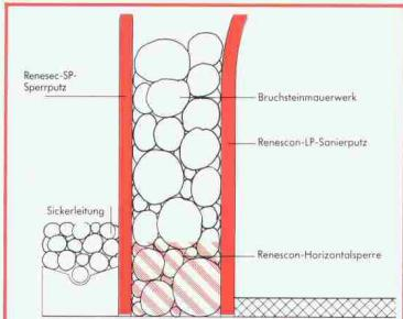
Die Reneson-Horizontalsperre verhindert das Aufsteigen der Feuchtigkeit. Das Mauerwerk trocknet aus.
