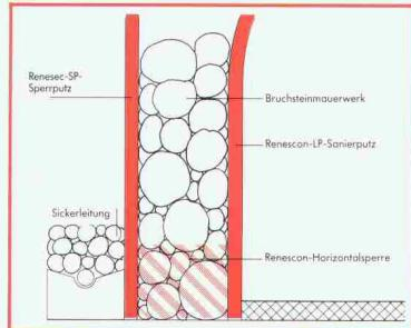
Die Renescon-Horizontalsperre verhindert das Aufsteigen der Feuchtigkeit. Das Mauerwerk trocknet aus.
