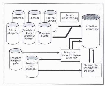
Bild 4. Rechnerunterstütztes Planungssystem der Gleisunterhaltungsarbeiten (Rivier)
