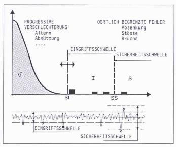
Bild 3. Grundlagen der Analyse des geometrischen Gleiszustandes (Rivier)
