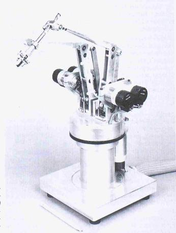
«Colibri», ein Prototyp eines Roboters, der am Institut für Mikrotechnik der ETH Lausanne (IMT) im Sinne der Miniaturisierung von Industrierobotern realisiert wurde  Die Optik spielt bei vielen Produkten der Mikrotechnik eine Rolle, sogar ausserhalb der eigentlichen optischen Geräte. Glasfaseroptik, kohärente und integrierte Optik sind von den Laboratorien der Physiker zu den Mikrotechnikprodukten vorgedrungen, wie es das Beispiel CD-Spieler zeigt.
