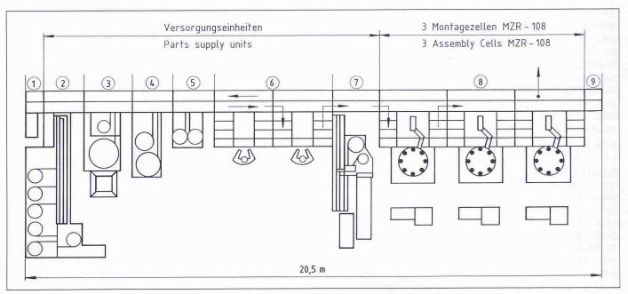
Bild 9. Layout der Montageanlage für Getriebemotor; 1 und 9 Umlenkmodule für den Palettentransport; 2 Vormontage des Ritzels; 3 Doppelversorgung für Zuführung des Schaltrades und des Deckels; 4 Versorgungseinheit für Platine und Stützbügel; 5 Versorgungseinheit für Schnecken- und Stirnrad; 6 Handarbeitsplätze; 7 Vormontage Motor; 8 Montagezellen
