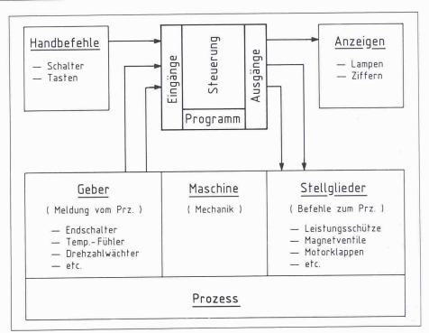
Bild 6. Steuerung von Montageanlagen
