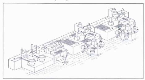
Bild 3. Flexibles Montagesystem mit Scara-Industrie-Roboter
