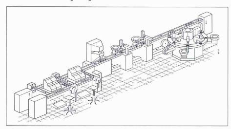
Bild 2. Linear-Transfer-Montageanlage
