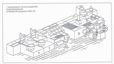
Bild 7. Flexibles Montagesystem Ratiogyr; 1 Automatische Versorgungseinheit; 2 Handarbeitsplatz; 3 Flexible Montagezelle
