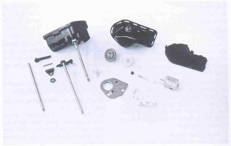
Bild 8. Getriebemotor als Objekt einer flexiblen Montageanlage
