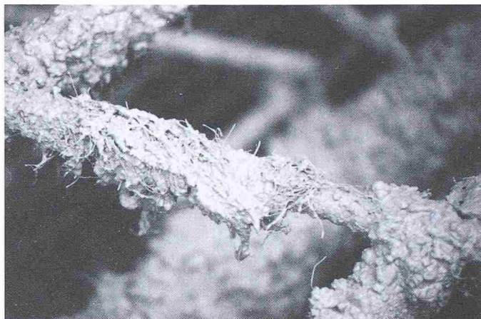
Bild 10. Faser-Entmischung beim Betonieren von Wänden im freien Fall
