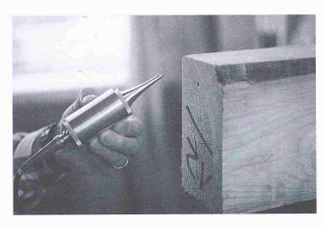
Bild 3. Ultraschallsender/-fühler mit stumpfer Spitze, die stirnseitig ins nasse Nadelholz eingedrückt werden kann
