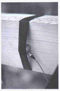
Bild 2. Mikrophon zur Detektion von Schallemissionen während einer Labor-Biegeprüfung an der EMPA
