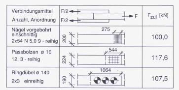
Bild 6. Vergleich der erforderlichen Anschlussflächen für verschiedene Verbindungsmittel bei einem Zugstoss
