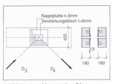
Bild 26. Anschluss an den Obergurt
