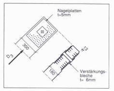
Bild 24. Anschluss der Diagonalen D<sub>3</sub>
