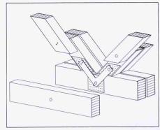
Bild 20. Knoten mit gleicher Teiligkeit der angeschlossenen Stäbe. Kraftübertragung durch Zwischenbleche
