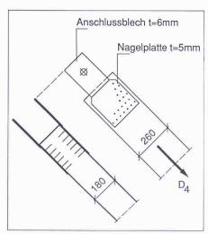
Bild 25. Anschluss der Diagonalen D<sub>4</sub>
