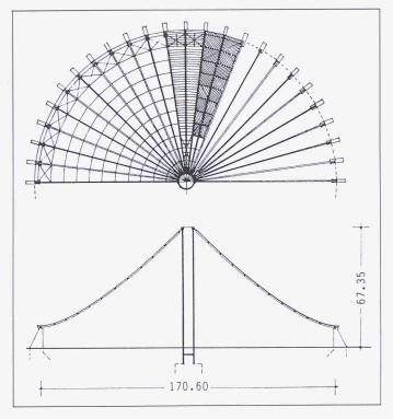
Bild 38 (rechts). Das Tragsystem in Grundriss und Schnitt
