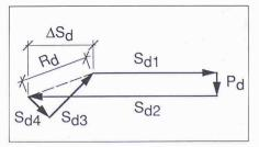
Bild 27. Kräfteplan zur Ermittlung der an den Obergurt anzuschliessenden Kraft
