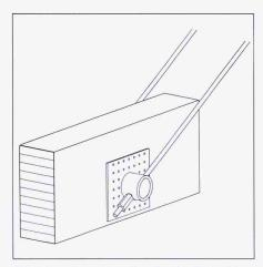
Bild 16. Anschlussdetail mit Gelenkbolzen (Rohrquerschnitt) und schraubbarem Armierungsstahl
