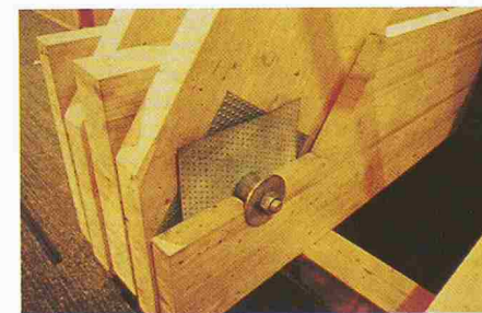
Bild 3. Schnittmodell eines Fachwerkknotens mit 2-teiligen Diagonalen und 3-teiligem Gurt. Der Gelenkbolzen ist eine Stahl-Stahl-Verbindung. Es gibt keine direkte Kraftübertragung zwischen dem Gelenkbolzen und dem Holzquerschnitt
