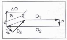
Bild 2. Tragwirkung des Knotens: Die Anschlusskräfte D₃ und D₄ werden über die Nagelbleche in den Bolzen übertragen. Dieser leitet die resultierende Kraft R weiter in die Gurtungen
