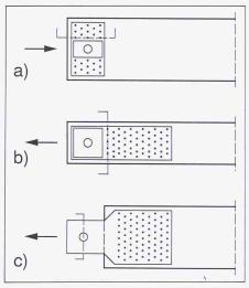
Bild 13. Die an den Nagelblechen zu führenden Nachweise sind von der Blechform abhängig
