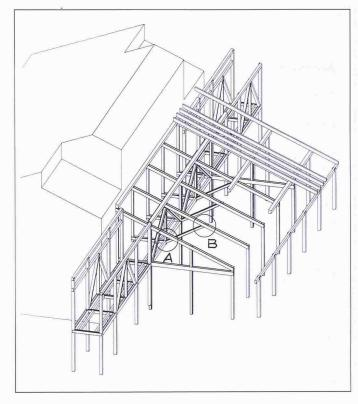
Bild 29 (rechts). Isometrie der Holzkonstruktion. Jeder zweite Querträger stützt sich auf den Längsträger des Verbindungsganges ab
