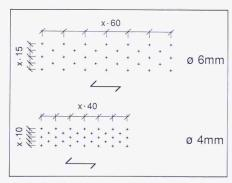
Bild 14. Mögliche Anordung der Nägel. Die Anschlussfläche für 1 kN beträgt 6,0 cm² für Nägel D = 6 mm resp. 5,3 cm² für Nägel D = 4 mm
