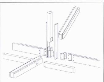
Bild 32. Explosionszeichnung des Anbschluss' A. Als Gelenk-
