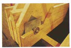
Bild 3. Schnittmodell eines Fachwerkknotens mit 2-teiligen Diagonalen und 3-teiligem Gurt. Der Gelenkbolzen ist eine Stahl-Stahl-Verbindung. Es gibt keine direkte Kraftübertragung zwischen dem Gelenkbolzen und dem Holzquerschnitt
