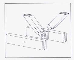
Bild 19. Einsatz von eingeschlitzten Blechen und Passbolzen anstelle von Nagelblechen
