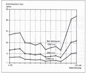
Bild 3. Amortisationszeit bei Motoren verschiedener Leistungsgrössen in Abhängigkeit von der durchschnittlichen Betriebsdauer pro Jahr
