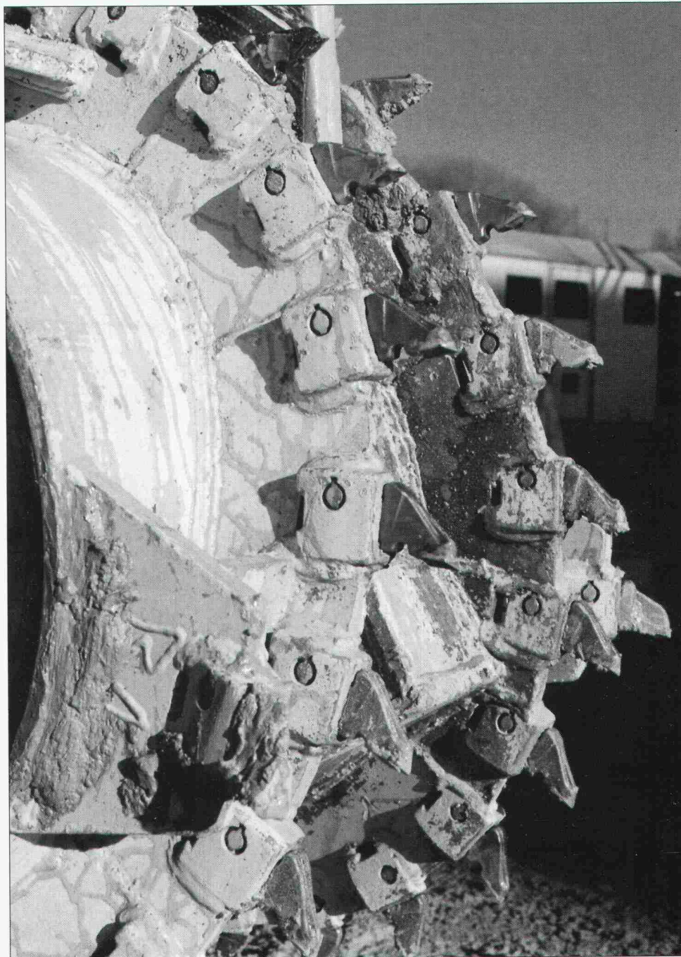
Detail des Fräsenrades mit den Hartmetallzähnen.
