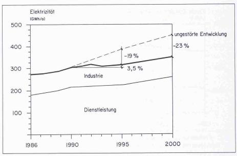
Bild 1. Erwarteter Verlauf des Elektrizitätsverbrauchs aller acht Unternehmen bis ins Jahr 2000. Die Reduktion des Netzbezugs zwischen 1992/93 resultiert aus der geplanten Inbetriebnahme der WKK-Anlage in der Papierfabrik an der Sihl.
