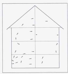
Bild 1. Seitenriss Wand gegen Nachbarhaus mit Körperschall-Intensitätsvektoren
