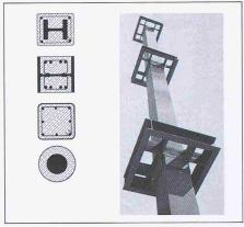
Bild 9. Querschnittsausbildung von Verbundstützen, Stahlpilz als wirksame Durchstanzsicherung
