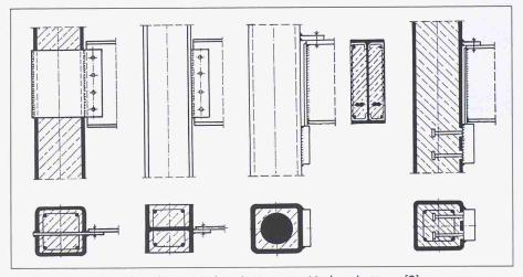
Bild 10. Anschlussdetails von Verbundträgern an Verbundstützen [2]
