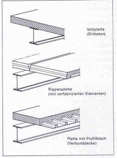
Bild 6. Konstruktionsmöglichkeiten von Deckenplatten auf Stahlträgern
