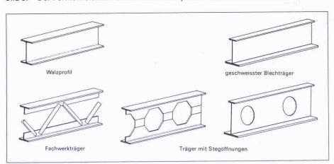
Bild 7. Konstruktionsformen von Deckenträgern und Unterzügen
