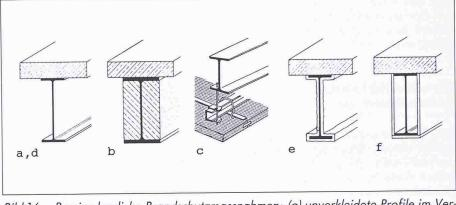
Bild 16. Passive bauliche Brandschutzmassnahmen: (a) unverkleidete Profile im Verbund mit Betondecken für Feuerwiderstandsdauern bis F30, (b) kammerausbetonierte Profile [9], (c) feuerwiderstandsfähige Unterdecken, (d) Brandschutz-Farbanstriche, (e) Sprays und Putze, (f) Verkleidungen
