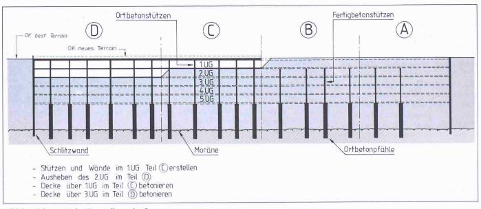
Bild 8. Schematische Darstellung des Bauvorganges
