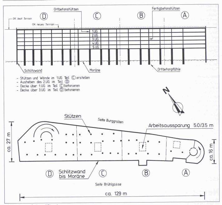
Bild 1. Längsschnitt und Situation
