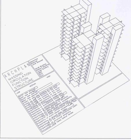
Bild 4. Expertensystem zur Generierung von Büro-Hochhäusern. Modul zur Plazierung der Aufzüge. Forschungsprojekt unterstützt von der National Science Foundation, USA. Gerhard Schmitt, 1989
