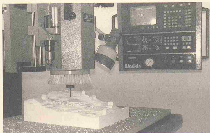
Modellherstellung durch NC-gesteuerte Fräsmaschine ab mittels CAD erstellter Zeichnung
