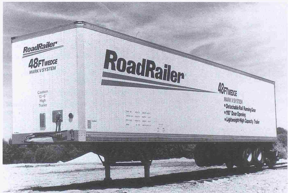
Das System RoadRailer bringt den Sattelaufleger direkt auf die Schiene. Hinten sitzt er auf einem Bahndrehgestell auf, vorne stützt er sich mit einer Spezialkupplung am nächsten Trailer ab
