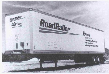
Das System RoadRailer bringt den Sattelauflieger direkt auf die Schiene. Hinten sitzt er auf einem Bahndrehgestell auf, vorne stützt er sich mit einer Spezialkupplung am nächsten Trailer ab
