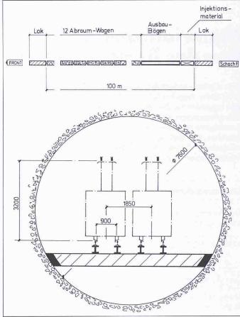
Bild 3/4. Zugskompositionen für die beiden Tunnel-Typen (V20 links, V38 rechts)
