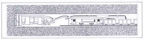
Bild 2. Schematische Darstellung des Verlades des Ausbruchmaterials in die Transportzüge
