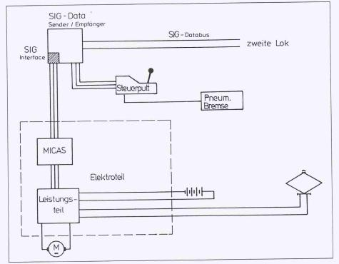
Bild 9. Blockschema des konventionell ausgeführten Starkstromteils
