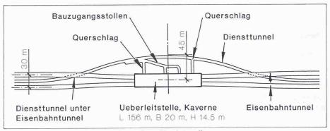
Bild 6. Grundriss-Skizze der britischen Überleitstelle
