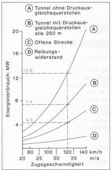
Bild 4. Einfluss der Druckausgleichsquerstollen auf den Energiebedarf
