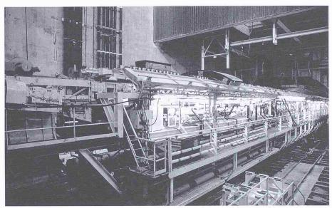
Bild 8. Teilansicht des 236 m langen Nachläufers der Tunnel-Vortriebsmaschine von Bild 7 (Photo Ph. Demail)
