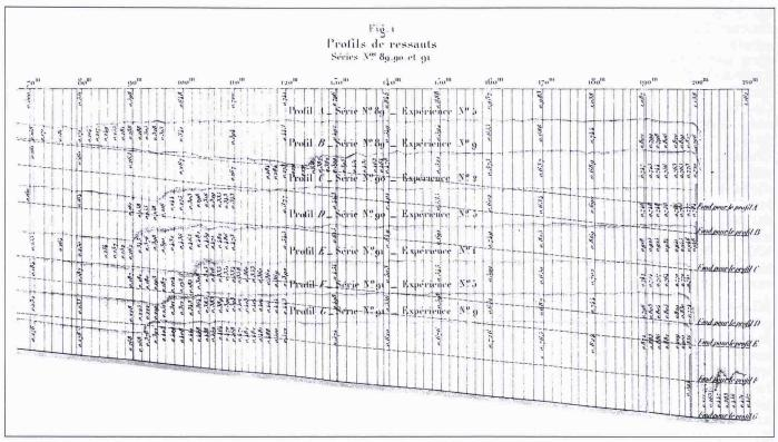
Bild 4. Oberflächenprofile der Serien 89, 90 und 91 nach Darcy und Bazin (1865)
