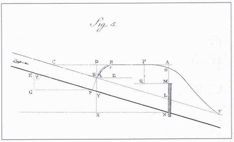
Bild 2. Längsschnitt eines durch eine Querschwelle erzwungenen Wassersprunges (Original-Figur 5 nach Bidone 1820)
