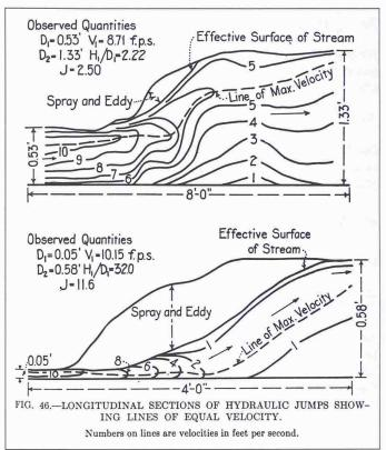
Bild 8. Längsschnitte von Wassersprüngen mit Linien gleicher Geschwindigkeit für  $\mathbf{F}_1 = 2.2$  (oben) und  $\mathbf{F}_1 = 8.0$  (unten) nach Riegel und Beebe (1917)
