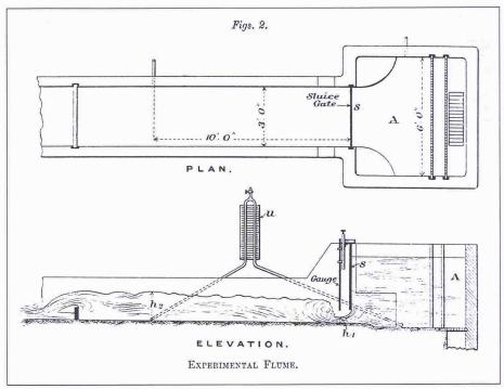
Bild 6. Messanordnung nach Gibson (1914)
