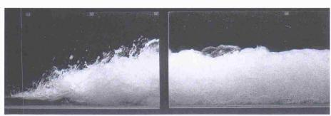
Bild 1. Typischer Wassersprung bei  $\mathbf{F}_1 = 5$
