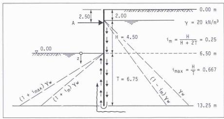
Bild 5. Geometrie einer einfach abgestützten, abgeschlossenen Baugrube mit den entsprechenden Wasserdruckverteilungen für homogenen, isotropen Baugrund mit  $i_m$  und homogenen, anisotropen Baugrund mit  $i_{max}$
