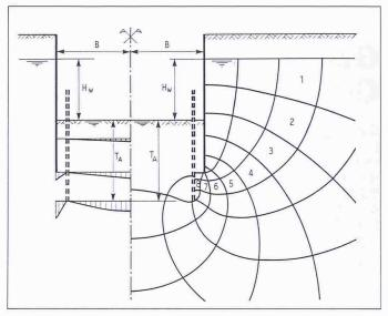
Bild 2. Baugrube wie Bild 1, jedoch Einbindetiefe auf 0.6 · T reduziert. Beeinflussung des Strömungsbildes (rechts) und der Porenwasserüberdrücke (links) durch eingebaute Drains
