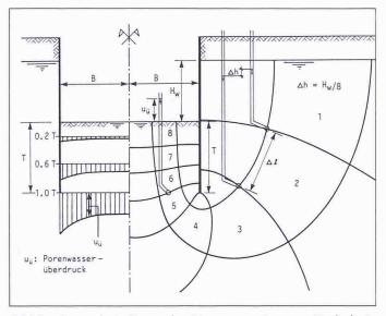
Bild 1. Querschnitt Baugrube. Homogene, isotrope Verhältnisse ( $k_h = k_v$ ), rechts das Strömungsbild mit 8 Potentialstufen  $\Delta h$ , links die qualitativen Porenwasserüberdrücke in den Tiefen  $0.2 \cdot T$ ,  $0.6 \cdot T$  und T ab Baugrubensohle
