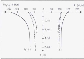
Bild 7. Momentenverlauf und Grösse der Abstützkraft in Funktion der Absenktiefe z in der Baugrube für Fall 1: homogener, isotroper Boden,  $i_m$ ,  $F_H = 4$ ; Fall 2: homogener, anisotroper Boden,  $i_{max}$ ,  $F_H = 1.5$ ; Fall 3: homogener, isotroper Boden,  $i_m$ , Einbindetiefe für volle Einspannung  $T = 3.55 \, \text{m}$ ,  $F_H = 2.58$ .
