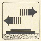
Gleitlager, grün: Dieses Punktlager mit 3 tragenden Kernen pro m1 deckt auch grosse Bewegungen (über ±10 mm) ab. Durch die einzigartige Konstruktionsart - es gleitet hier Teflon auf Teflon - ist es gelungen, die Reibung dauerhaft auf nur etwa 1% der Auflast zu reduzieren. Die maximale Belastung beträgt 450 kN/m1.
