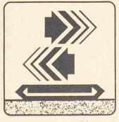
Limitgliss-Lager, rot: Die patentierte Konstruktion erlaubt es, die grossen, im Rohbau auftretenden Bewegungen im Bereich von ±10 mm abzudecken und wirkt später als normales Verformungslager. Das Limitgliss-Lager wird ebenfalls als Linienlager hergestellt und ist ausgelegt für Lasten von bis zu 400 kN/m1.
