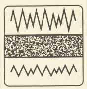
Resobloc-Lager, schwarz: Hier handelt es sich um ein Akustiklager, welches durch seine Positionierung am Wandfuss die Übertragung von Körperschall dämpft. Auf der oberen Seite befindet sich eine Folie, welche sowohl das Eindringen von Mörtel als auch das Aufsteigen von Feuchtigkeit verhindert. Um der Verwechslungsgefahr auf der Baustelle zu begegnen, wird es nur in einer Stärke (6 mm) hergestellt. Die Belastbarkeit beträgt 1,5 N/mm<sup>2</sup>.
