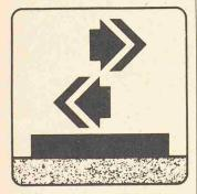
Verformungslager, blau: Dieses Linienlager kann für Lasten bis 750 kN/m1 eingesetzt werden und erlaubt horizontale Verschiebungen von ±2 mm (Dicke 5 mm) und von ±4 mm (Dicke 10 mm).
