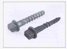
Bild 1. Erhebliche Querschnittsverminderung einer Eisenbahn-Schwellenschraube durch Korrosion
