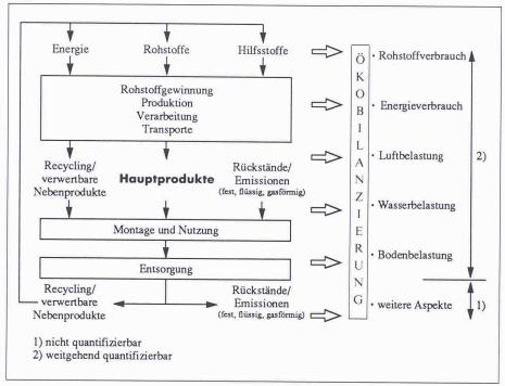
Bild 1. Betrachtungs- und Zielgrössen bei der Erstellung einer Ökobilanz
