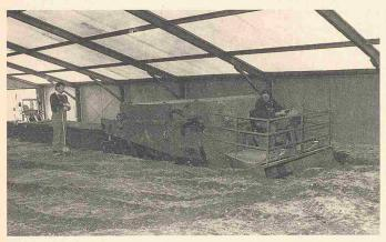
Das in Zelten gelagerte Material muss kontinuierlich belüftet und durchmischt werden
