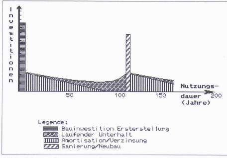
Bild 1. Schematischer Kostenverlauf/Nutzungsdauer
