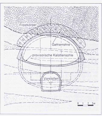
Bild 3. Profil im Bereich des Gegenvortriebes
