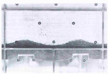
Bild 2. Deformationen einer armierten Granulatfüllschicht bei Modelltests mit unbefestigten Strassen.
