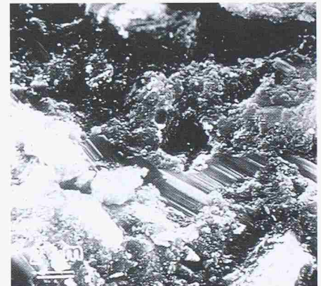
Bild 3a. Normalbeton unter dem Mikroskop
