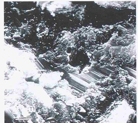
Bild 3a. Normalbeton unter dem Mikroskop
