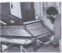
Die mit dem Fensterfutter ergänzten Dachflächenfenster werden im Werk mit der Dampfsperre (Bild), der Wärmedämmschicht und dem fugenlosen Unterdach versehen
