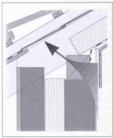
Fehlstelle bei Bauteilübergängen, z.B. Aussenwand/Steildach im Traufbereich:
