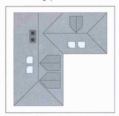
Die Durchlüftung ist bei geometrisch komplizierten Dachstühlen, mit Graten, Kehlen und Aufbauten, nicht gewährleistet.
