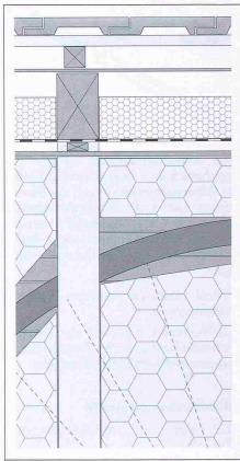
Fehlstelle in der Ebene der Wärmedämmschicht, in Bereichen von nicht ortogonalen Grundrissgeometrien:
