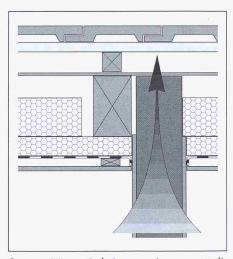
Raumseitiges Anbringen einer zusätzlichen Wärmedämmschicht (die Wärmeund dampfdiffusionstechnische Funktionstüchtigkeit muss objektspezifisch geprüft werden). Wärmebrücken bei durchdringenden Innenwänden o.ä. können nicht eliminiert werden.
