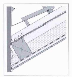
Wasserinfiltrationen bei aufgehenden, das Steildach durchdringenden Bauteilen:
