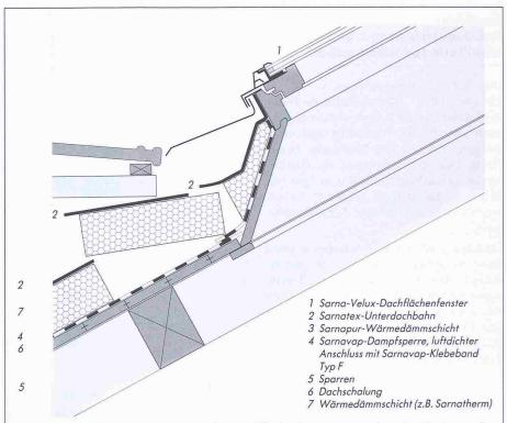
Auf der Baustelle muss das Sarna/Velux-Dachflächenfenster nur noch in der Fläche an die entsprechenden Schichten des wärmgegedämmten Steildaches angeschlossen werden
