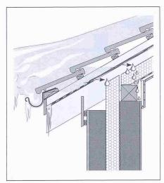
Vordachbereich und bildet dadurch eine Eisbarriere
