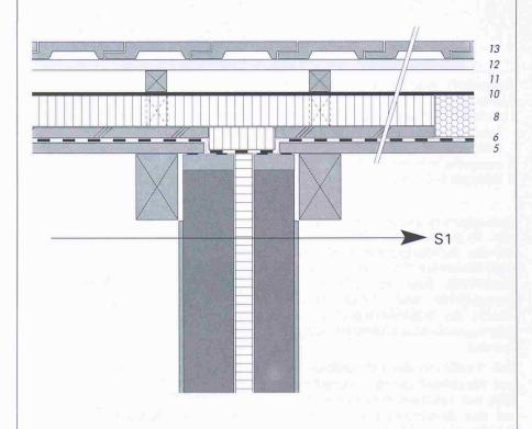
Funktionstüchtige Ausbildung (Neubau nach Sanierung), R'w≈ 59 dB S1 Schallübertragung über die Trennwand (ohne das Schalldämmvermögen beeinflussende Nebenwegübertragungen)
