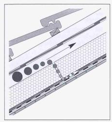
Kalte Aussenluft gelangt via Durchlüftungshohlraum in den Bereich zwischen der Wärmedämmschicht und der Dampfbremse/-sperre, die Wärmedämmschicht wird von der kalten Aussenluft unterwandert, das Wärmedämmvermögen beeinträchtigt und die Konstruktion ausgekühlt:
