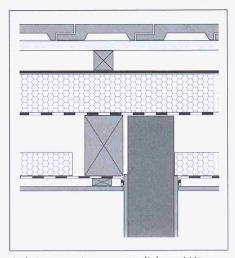
Anbringen einer zusätzlichen Wärmedämmschicht im Warmdachsystem, z.B. mit einem SarnaPanel Standard. Wärmebrücken bei durchdringenden Innenwänden o.ä. können eliminiert werden.
