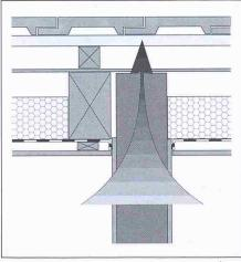
Wärmebrücke bei Zwischenwänden:
