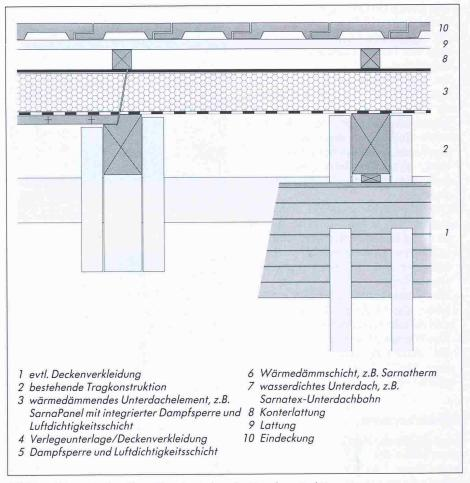
Bild 1. Warmdachaufbau über bestehender Tragkonstruktion
