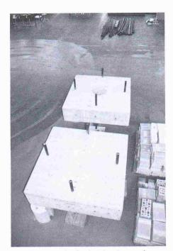
Bild 9. Ansicht der beiden Betonplatten. Vorn: Platte B (stark armiert), hinten: Platte A (schwach armiert)
