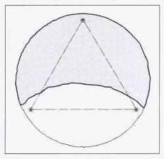
Bild 11. Anomalie mit 2 Messröhren ausserhalb des Betonquerschnittes
