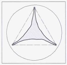
Bild 13. Theoretischer Restquerschnitt («Mercedesstern»), kein Messrohr ohne Betonkontakt
