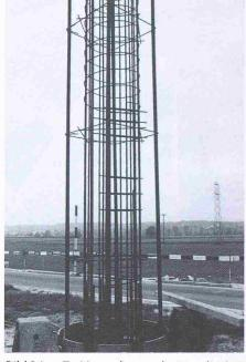
Bild 16. Zu Versuchszwecken ist die Spiralarmierung teilweise unterbrochen
