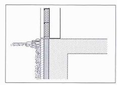
Bild 2. Vorgehängte Fassade: kein Wärmebrückenproblem
