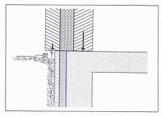
Bild 3. Zweischalen-Mauerwerk. Auflager für Aussenschale fehlt
