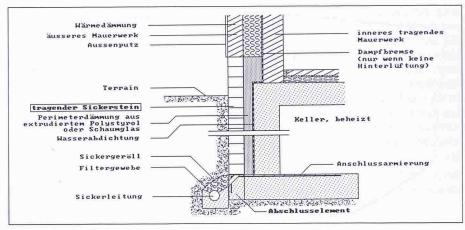
Bild 8. Zweischalen-Mauerwerk: Lösung mit tragendem Sickerstein
