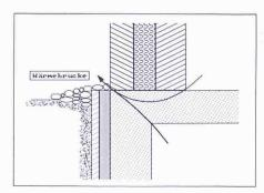
Bild 5. Zweischalen-Mauerwerk: konventionelle Lösung mit Wärmebrücke
