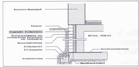
Bild 9. Einsteinmauerwerk: Lösung mit tragendem Sickerstein
