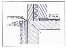
Bild 6. Zweischalen-Mauerwerk: Lösung mit Thermur-Element. Wärmebrükke zu Kellerraum ungelöst
