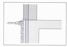
Bild 1. Kompaktfassade: kein Wärmebrückenproblem
