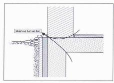
Bild 4. Einsteinmauerwerk mit Wärmebrücke
