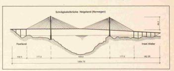
Basel auf dem Wasserweg. Die Längsschnitt der Schrägkabelbrücke «Helgeland»
