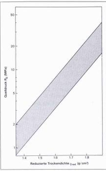
Bild 2. Der Verlauf des Quelldruckes P<sub>Q</sub> von hochkompaktiertem Bentonit in Abhängigkeit der sogenannten reduzierten Trockendichte Q<sub>red</sub> (d.h. der Enddichte des Bentonits, nachdem alle Fugen und Spalten durch die Quellung gefüllt wurden). Die schraffierte Fläche zeigt die durch die Messgenauigkeit, die Qualitätsschwankungen und die Temperatur bedingte Bandbreite
