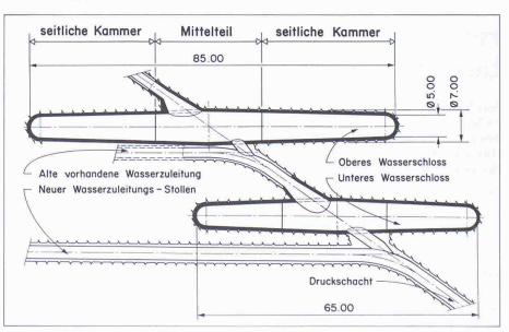
Bild 2. Längsschnitt durch Wasserschloss
