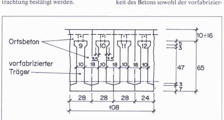
Bild 5. Querschnitt der ersten vorgespannten Eisenbahnbrücke der Schweiz
