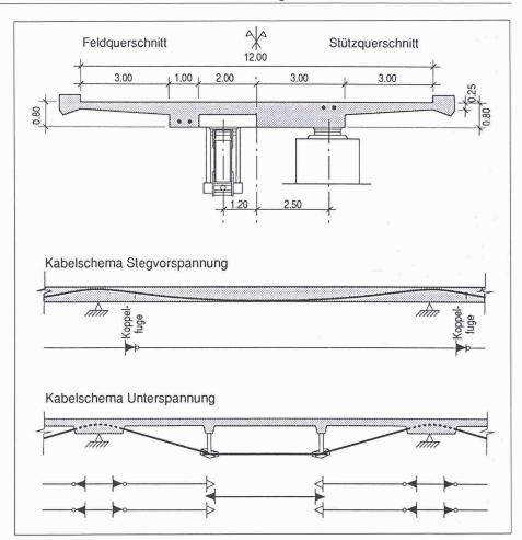
Bild 6. Querschnitte sowie Kabelschema der unterspannten Plattenbrücke
