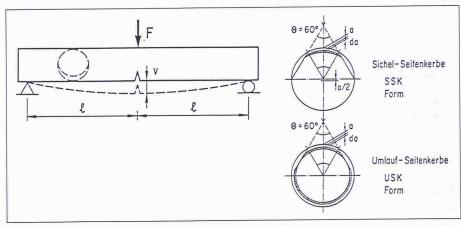
Bild 2. Scharfkerbproben für Draht- und Stangenprüfung mit bruchmechanischer Auswertung
