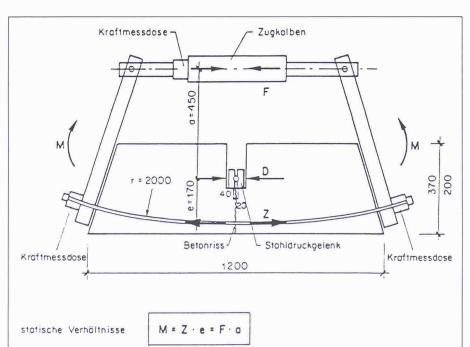
Bild 1. Vorgespannter Versuchskörper für Reib- und Ermüdungsversuche
