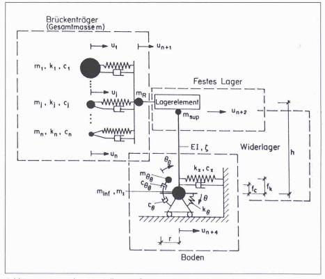
Bild 7. Dynamisches Modell zur Erfassung des Erdbebenverhaltens von Balkenbrükken mit fester Lagerung in Längsrichtung
