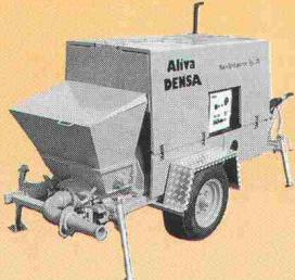
Für das Nass-Spritzverfahren haben wir deshalb ein völlig neues Funktionsprinzip entwickelt, welches dem Profi Vorteile bringt. Erstmals wird das Spritzgut geradlinig gefördert, was die Strömungs- und Druckver-
