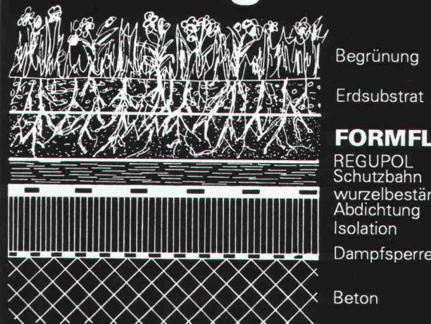
**FORMFLOR** bietet einen optimalen Wasser-Luft-Haushalt für Schräg-, Flach-, und vertikale Begrünung. Die geringe statische Belastung ermöglicht vielfältige Anwendungen.
