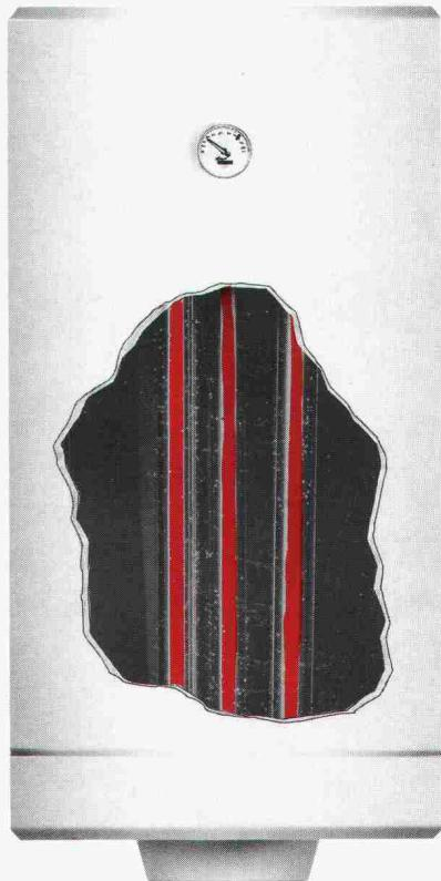
Blick ins Innere des Boilers. Die erhitzten, metallischen Infrarot-Strahler werden von Glas umhüllt und kommen nicht mit dem Wasser in Berührung. Die Strahlungsgennergie im Infrarot-Bereich gelangt ohne materielle Träger direkt ins Wasser.
