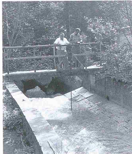
Bild 1. Flügelmessung Albach-Erstfeld, Bodenberg
