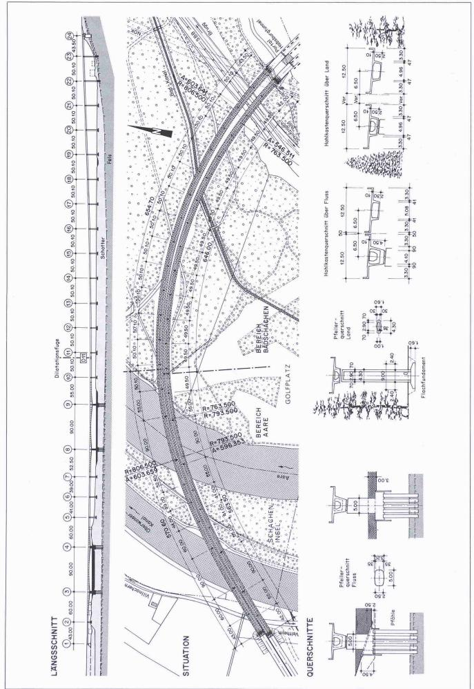
Bild 2. Längsschnitt, Situation und typische Querschnitte
