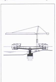
Bild 6. Bauvorgang Überbau Bereich Aarebrücke (Oberwasserkanal und Aarelauf)
