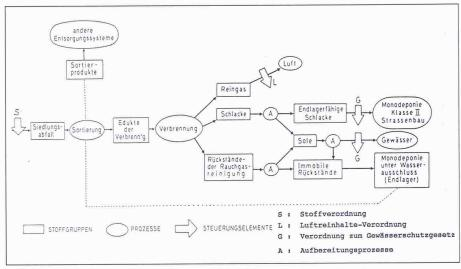
Bild 3. Schematische Darstellung des Stoffflusses durch das Entsorgungssystem Verbrennung
