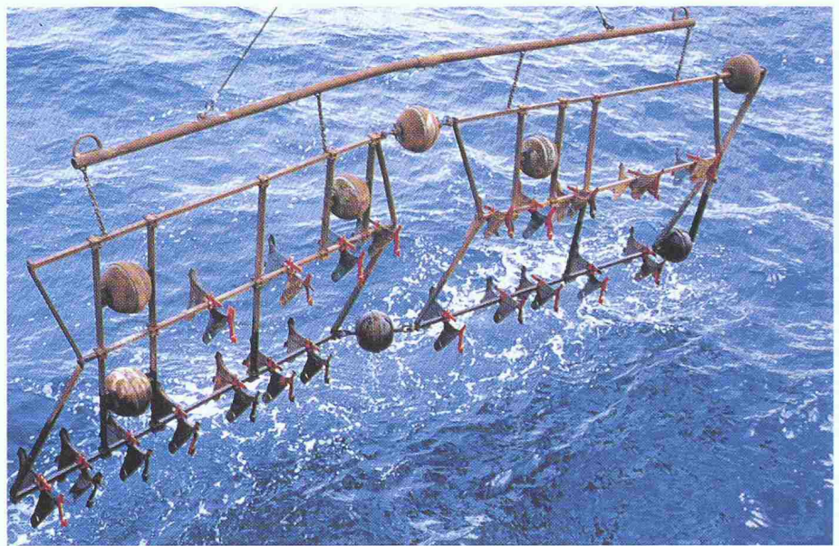
Die 8 m breite «Pflugegge», mit der das Manganknollenfeld beeinflusst wurde, kurz vor dem Einsatz (Bild: H. Thiel)
