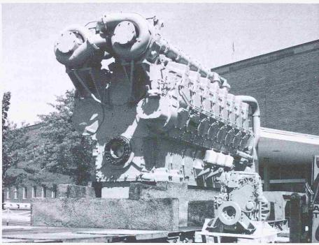
Bild 3. Notstromdieselmotor
