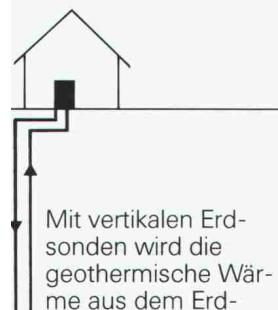
Mit vertikalen Erdsonden wird die geothermische Wärme aus dem Erdinnern genutzt. Die bis zu 120 m tiefen Sonden profitieren von der konstanten Erdtemperatur von 8–10°C.
