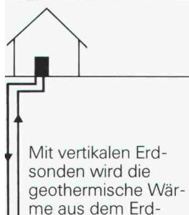
Mit vertikalen Erdsonden wird die geothermische Wärme aus dem Erdinnern genutzt. Die bis zu 120 m tiefen Sonden profitieren von der konstanten Erdtemperatur von 8–10°C.
