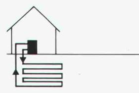
Mit horizontal verlegten Erdkollektoren wird die Sonnenwärme der obersten Erdschicht genutzt. Die Erdkollektoren werden in einer Tiefe von 1,50 m verlegt.
