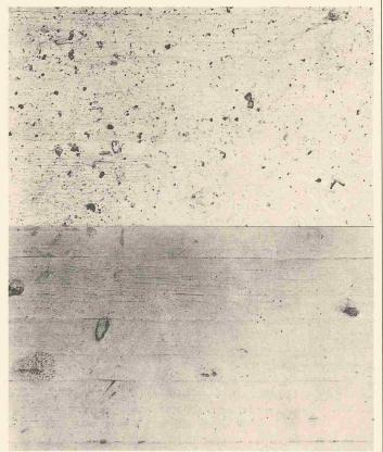
Oben: Betonoberfläche, wo Schalung nicht vorbereitet worden ist; grosse Lufteinschlüsse sichtbar. Unten: Eine mit Rheofinish behandelte Schalung ergibt eine fast porenfreie Betonoberfläche
