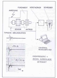
Bild 11. Ermittlung von Fundamenteigenfrequenzen, typische Abklingkurven
