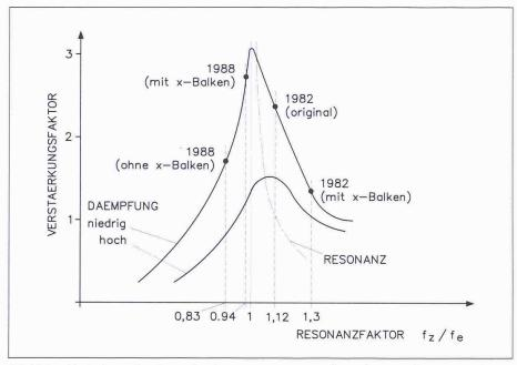
Bild 16. Verhalten des Betonfundamentes unter Einfluss dynamischer Zusatzbeanspruchungen
