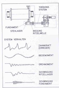
Bild 2. Dynamisches Verhalten eines Ritzelantriebes
