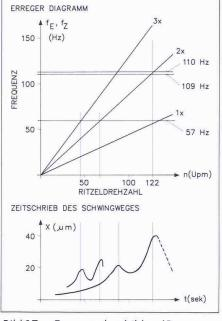
Bild 17. Erregerschaubild und Resonanzverhalten
