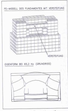
Bild 14. FE-Modell mit Versteifung und resultierende Eigenform
