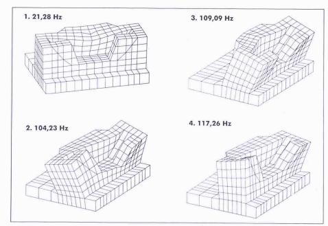
Bild 10. Eigenverhalten eines Fundamentes bei verschiedenen Eigenfrequenzen
