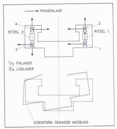
Bild 12. Durch Messung ermitteltes Eigenverhalten eines Fundamentes
