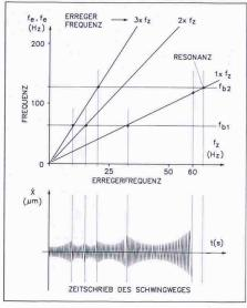
Bild 8. Erregerschaubild eines Hochlaufes
