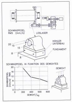
Bild 19. Eigenfrequenzproblem am Ritzelstehlager
