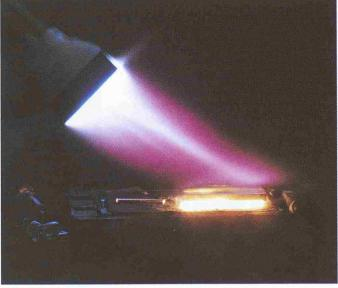
Auf den schräg angeordneten Sinterkörper (links) trifft der ultraviolette und deshalb unsichtbare Laser-Strahl. Er löst dort Atome und Atomverbände (Cluster) ab, die zum waagerecht liegenden, gelbrötlich leuchtenden Substrat (unten) fliegen und ihren Weg durch violettes Plasmaleuchten verraten (Bild: KFA)
