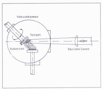
Vakuumgefäss des Forschungszentrums Jülich zur Herstellung von Supraleit-Dünnfilmen: Das hochenergetische Licht eines Excimer-Lasers reisst aus dem auf einer rotierenden Achse befindlichen Sinterkörper Material aus, das sich auf dem Substrat in der von diesem vorgegebenen Kristallstruktur niederschlägt
