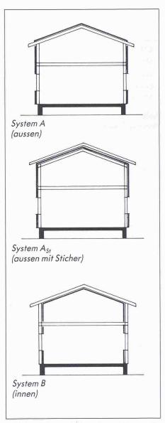
Bild 2. Schematische Darstellung der Dichtungskonzepte
