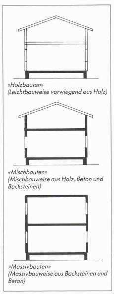
Bild 1. Bezeichnung der untersuchten Bauweisen
