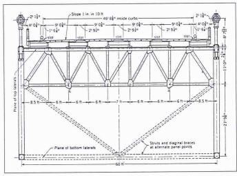
Bild 7. Querschnitt der zweiten Tacoma Narrows-Brücke (1948–50)
