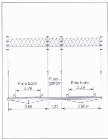
Bild 3. Querschnitt der Menai-Brücke (1818–26) mit Abstandhaltern zwischen den Kettensträngen
