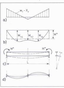
Bild 2. Versteifungsträger unter Querwind, a) Windlast, b) Biegemomente, c) Aufriss und d) Grundriss
