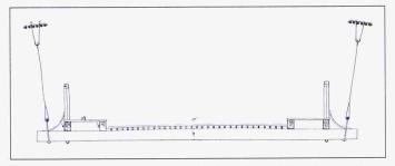
Bild 4. Querschnitt der Ohiobrücke Wheeling-Belmont (1847-49)
