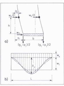
Bild 1. Aufteilung der seitlichen Windlast auf Kabel und Versteifungsträger (--- Näherung)
