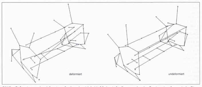
Bild 3. Deformierte und undeformierte Struktur der sich bei Luftfeder-Aufstellung ergebenden Torsionseigenform mit der Eigenfrequenz von 13,8 Hz
