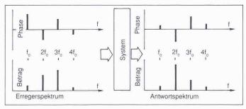
Bild 6. Bei der Spektren-Methode wird das Antwort-Spektrum auf ein für die Drehfrequenz  $f_0$  vorliegendes Erregerspektrum berechnet
