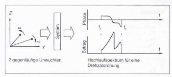
Bild 8. Bei der Unwucht-Methode wird mit den die Kräfte darstellenden Unwuchten für jede Drehzahlordnung je ein Hochlauf gerechnet
