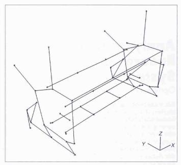
Bild 2. Idealisierte Webmaschinen-Struktur
