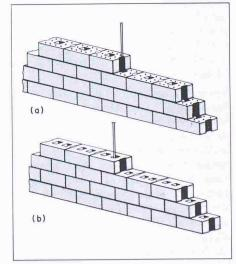
Bild 4. Anordnung von Spanngliedern im Mauerwerk: (a) In Handloch und Stossfugen; (b) In Steinlochung
