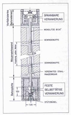
Bild 3. Spannglied für vorgespanntes Mauerwerk
