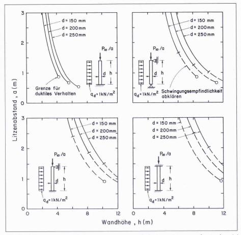
Bild 7. Diagramme zur Vorbemessung von querbelasteten Mauerwerkswänden: (a) Kragarm; (b) einfach gelagerte Wand; (c) eingespannte, abgestützte Wand; (d) durchlaufende Wand
