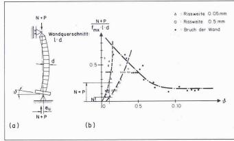
Bild 6. Einfluss der Vorspannkraft auf Rissweite und Bruchverformung von Mauerwerkswänden: (a) Versuchsaufbau; (b) Versuchsresultate [7]
