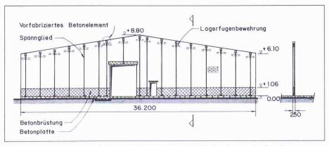
Bild 11. Vorgespannte Mauerwerkswand, Papierfabrik, Regensdorf: Abmessungen und Anordnung der Spannglieder
