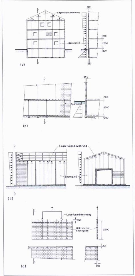
Bild 1. Anwendungen von vorgespanntem Mauerwerk: (a) Wohngebäude; (b) Kellerwand; (c) Ausfachungswände; (d) Vorfabrizierte Wand
