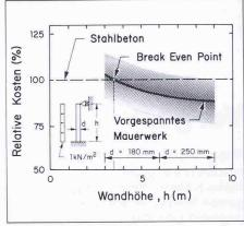
Bild 2. Kostenvergleich zwischen vorgespanntem Mauerwerk und Stahlbeton
